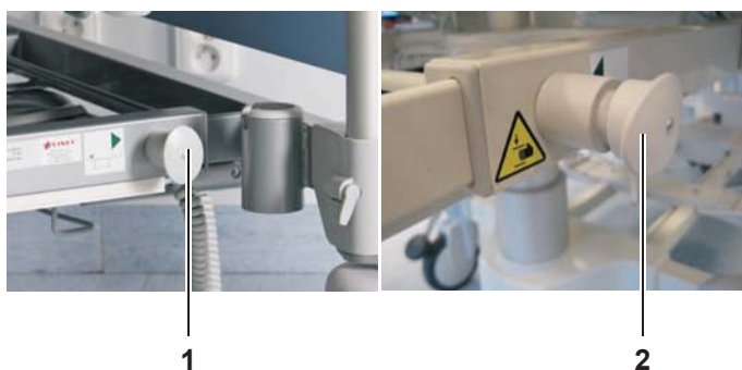
Obr.16 Aretační /bezpečnostní zámek zajišťující stabilní polohu prodloužení lůžka
