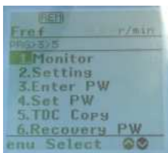
Obrázek 8. Menu nastavení hesla pro povolení funkce TDC
