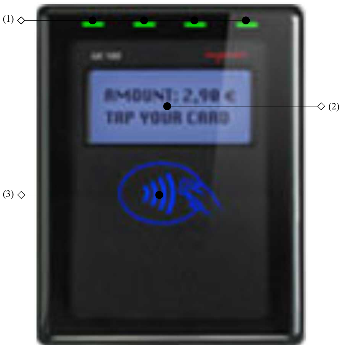
Obrázek 29: Rozmístění prvků terminálu pro akceptaci bezkontaktních platebních karet (1) Signalizační diody; (2) Informační displej; (3) Čtečka bezkontaktních platebních karet
