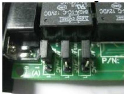
Obr.7 Nastavení můstků pro ACTIVE OPEN
