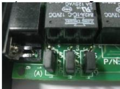
Obr.6 Nastavení můstků pro ACTIVE CLOSE
