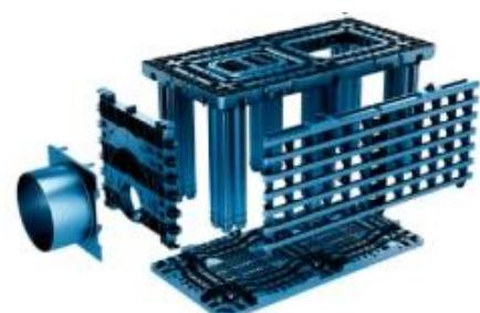
Akumulační plastový box je box o stavebním objemu 0,454m<sup>3</sup> se revizními kanály o šířce až 350mm ve dvou směrech a možnosti přímé inspekce na 70% půdorysné plochy. Přímé napojení na vstupní potrubí až do DN 400.
