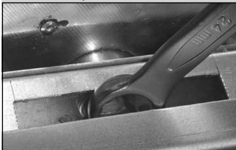
Obrázek 7 – Osový šroub uvolněte klíčem č. 24
