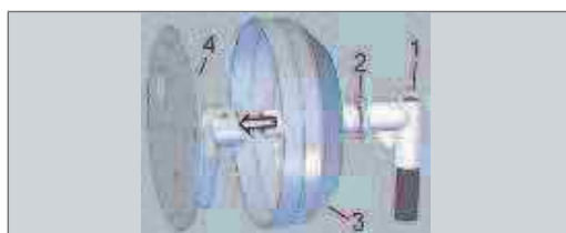
Kryt s kroužkem nasunout na nástěnný úhlový profil
