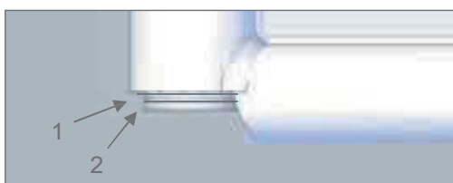
Nejprve nasadit podložku 1, poté pojistný kroužek 2
