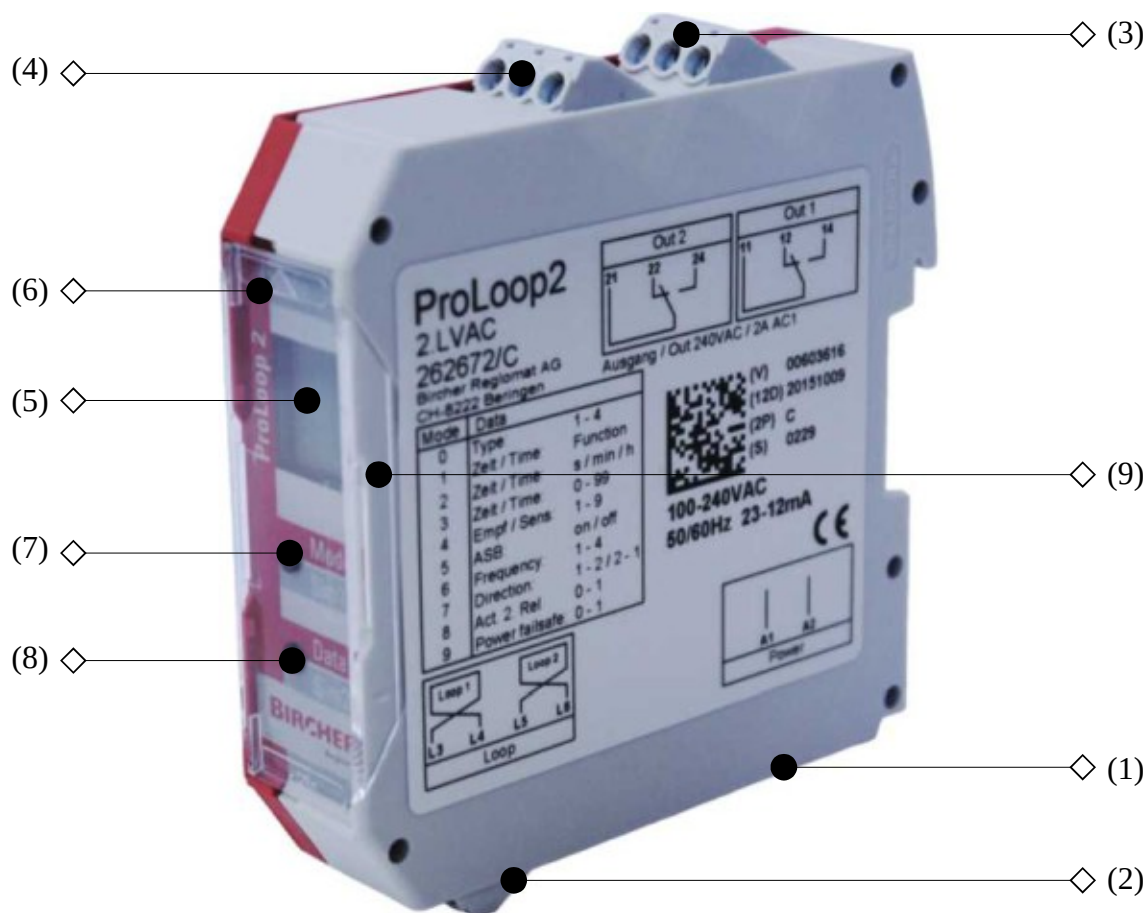
Obrázek 10: Součásti detektoru vozidel
