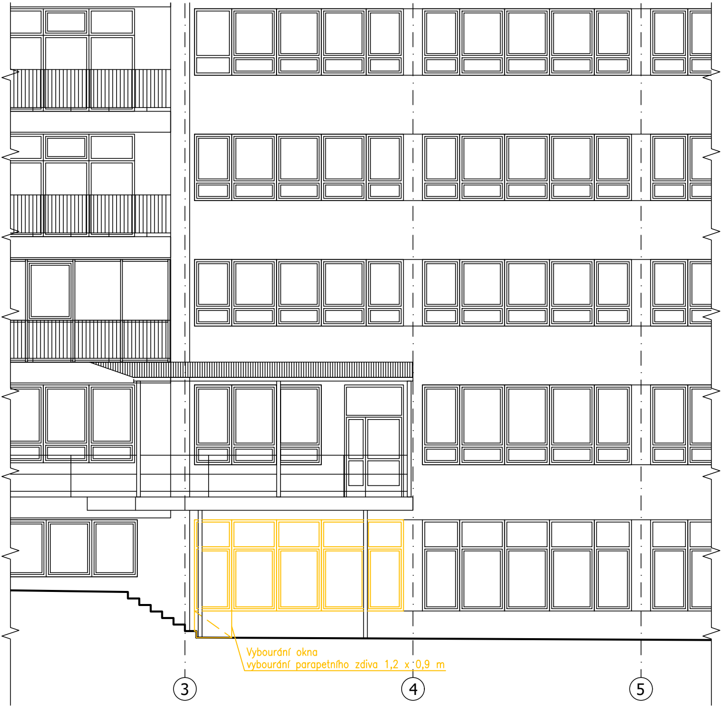
Q2 – Pohled JV– stávající stav + bourací práce
