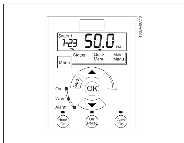
Obrázek 4.2: Panel LCP 11 bez potenciometru
