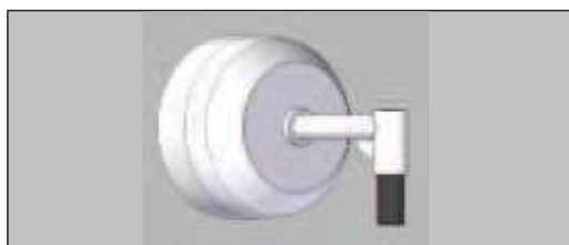
Kryt přisunout ke zdi Pevně sešroubovat dohromady s kroužkem
