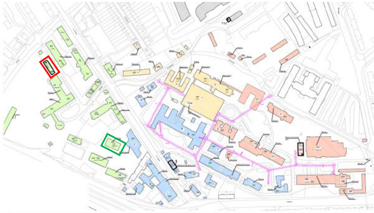
Obrázek 28 –Umístění fakturačního měření pro elektrickou energii objektu ubytovny YC
