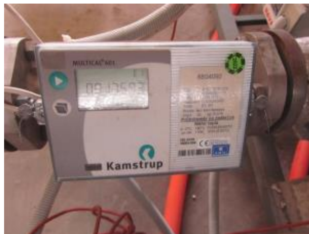
Obrázek 27–Kalorimetr Kamstrup MULTICAL pro měření tepla
