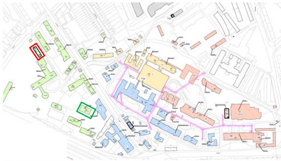
Obrázek 58 – Schéma napojení objektu Q na trafostanici
