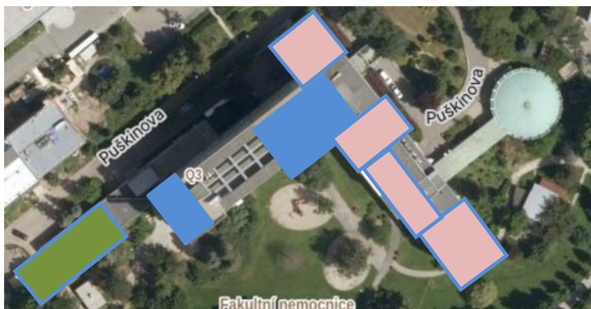
Obrázek 73 Využitelný prostor střechy pro umístění FV panelů objekt Q1 (označeno růžově), objekt Q2 (označeno modře), objekt WP (označeno zeleně)
