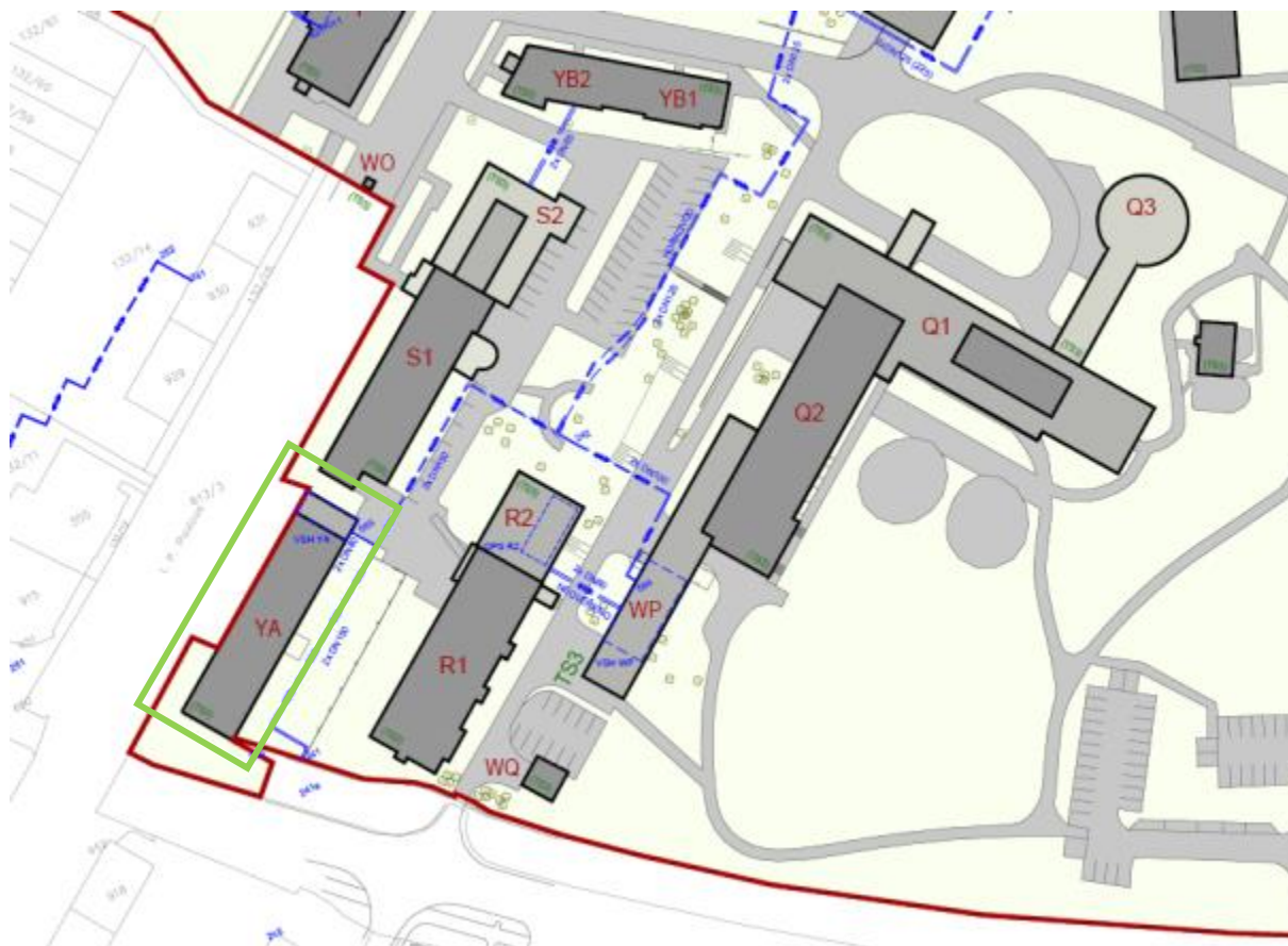
Obrázek 22 - Napojení objektu na horkovod a umístění OPS YA (zdroj: Generel, část B Výkresová část)
