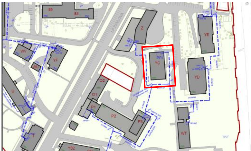
Obrázek 14 - Napojení objektu na horkovod a umístění OPS YC (zdroj: Generel, část B Výkresová část)
