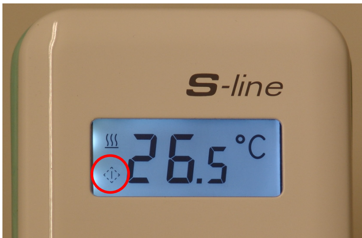
Obrázek 10: Displej se zakroužkovaným symbolem testu ochrany proti nadměrné teplotě
