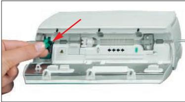
Die Freeflow-Klemme (siehe Pfeil) in gekennzeichnete Pfeilrichtung in den geöffneten Schlitz einschieben, bis der Entriegelungshebel schließt und die Sicherheitsklemme die Leitung zusammendrückt (blinkende Warnleuchte erlischt).
