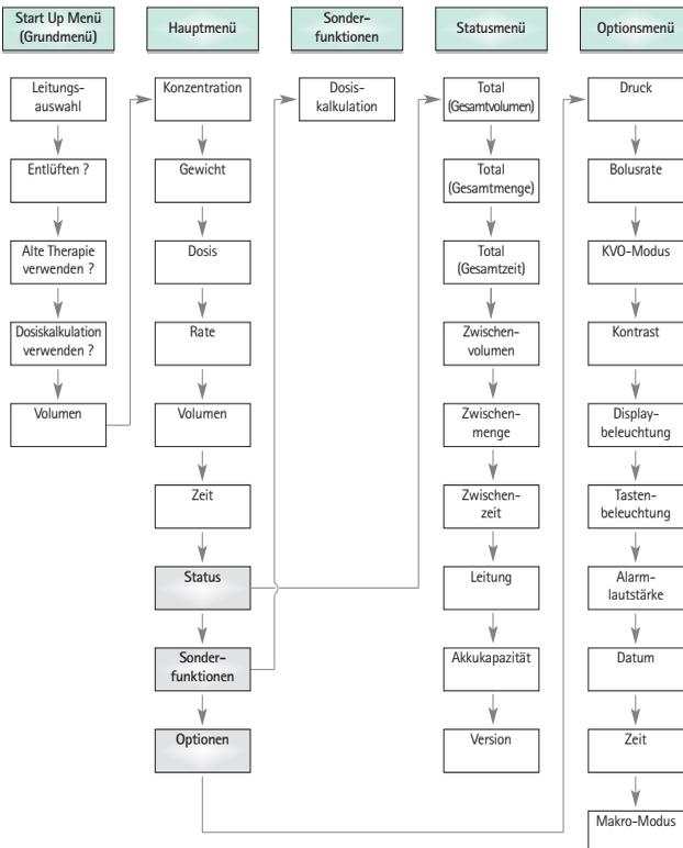
Die Pumpe kann den Anwenderbedürfnissen angepaßt werden, indem die Funktionen des Start Up- (Ausnahme: Volumen) und Optionsmenüs sowie die Bolusfunktion über das Serviceprogramm (de-)aktiviert werden.
