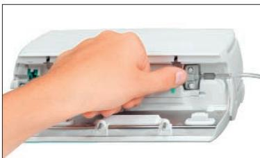
Infusionsleitung von rechts nach links gerade einlegen. Zuerst Leitung durch Upstreamsensoren führen. Danach zwei-löchrigen Clip einlegen.
