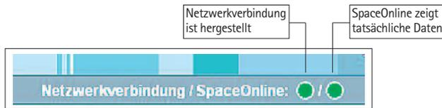
Mittels der beiden Status-Anzeigen, rot/gelb/grün, wird zum einen die Netzwerkverbindung zwischen PC bzw. Browser und SpaceOnline signalisiert und der Status von SpaceOnline überwacht. Die Anzeigen wechseln dynamisch ihren Zustand. Sollte über längere Zeit, 15 bis 20 Sekunden, eine der beiden Anzeigen rot signalisieren, liegt ein Fehler vor und die Informationen in der Anzeige sind nicht aktuell. Informationen zur Anzeige entnehmen Sie bitte der untenstehenden Tabelle:
