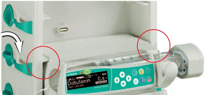
Zum Entriegeln drehen Sie den Knopf im Uhrzeigersinn in vertikale Position und die Pumpe kann entnommen werden. Nach der Entriegelung wird die Pumpe weiterhin durch die Führungsschienen in der SpaceStation gehalten, kann aber bei starker Erschütterung oder während des Transportes leicht herausfallen.
