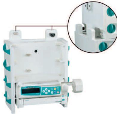
Das obere Segment wird von vorne auf das untere Segment aufgeschoben und mittels der Verriegelung im unteren Segment fixiert.
