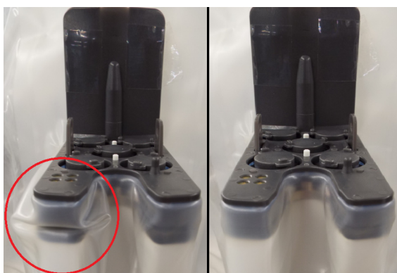
Figura 1 Bolsa de la funda atrapada (izquierda), bolsa de la funda lisa (derecha)
