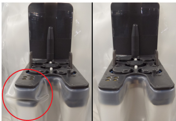
Afbeelding 1 Bekneld afdek materiaal (links), glad afdek materiaal (rechts)
