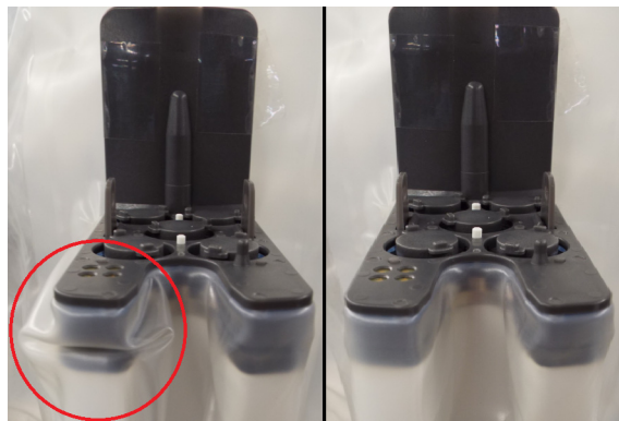
그림 1 잘못 끼인 드레이프 파우치 (왼쪽), 올바르게 설치된 드레이프 파우치 (오른쪽)
