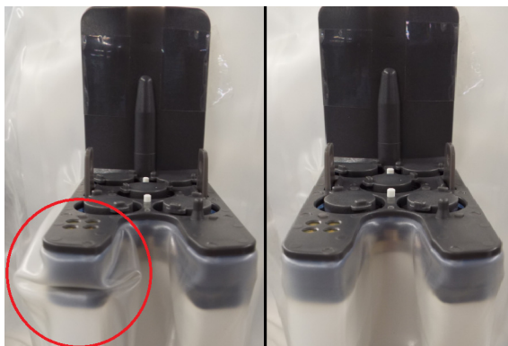
Εικόνα 1 Σφηνωμένη θήκη προστατευτικού καλύμματος (αριστερά), ίσια θήκη προστατευτικού καλύμματος (δεξιά)
