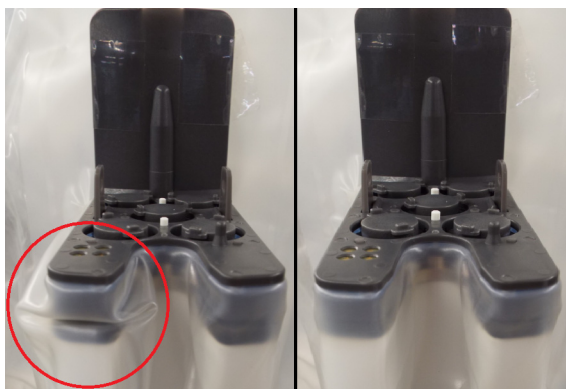
Figura 1 Sacca del telo schiacciata (sinistra), sacca del telo distesa (destra)
