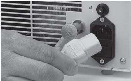
Netz Kabel anschließen, Netzstecker bis zum Anschlag in Netzbuchse ⑨ einschieben.
