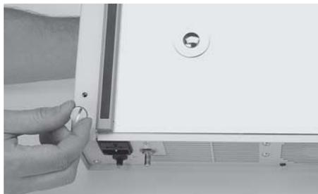
Gehäusehaube öffnen. Dazu zuerst die 2 Rändelschrauben an der Unterseite des Gerätes lösen.
