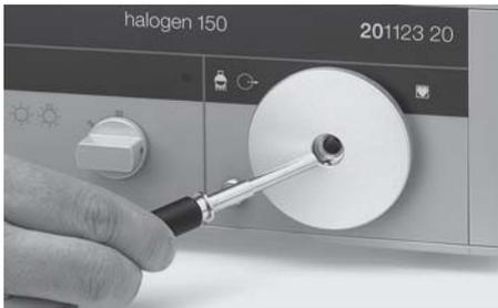
Lichtkabel bis zum Einrasten in Buchse ⑤ einschieben. Lichtkabel nur am Griffstück anfassen. Niemals am Kabel ziehen.
