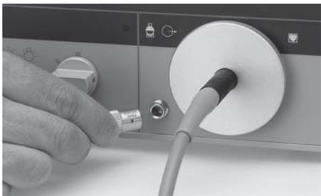
Wird das Lichtkabel nicht sofort mit dem Endoskop verbunden, ist das freie Ende an der Aufnahme ④ festzuschrauben.
