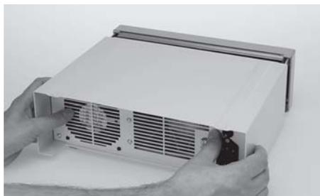
Das Gerät wieder umdrehen und die Gehäusehaube nach hinten schieben.
