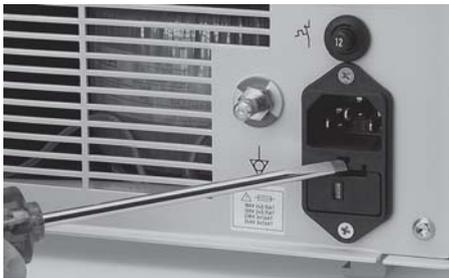
Netzsicherungshalter ⑧ mit einem geeigneten Werkzeug lösen.
