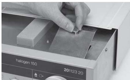
Lampenschachtdeckel entfernen. Dazu Rändelschraube lösen.
