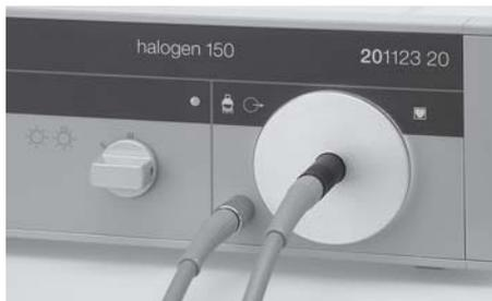
**Hinweis:** Häufiges Aus- und Einschalten der Kaltlicht-Fontäne führt zu erhöhtem Verschleiß der Halogenlampe. Bei kürzeren Unterbrechungen den Lichtintensitätsschalter (2) auf Stufe 1 stellen.
