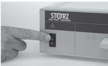
Gerät einschalten. Netzschalter ① und Betriebskontroll-Leuchte ③ leuchten.
