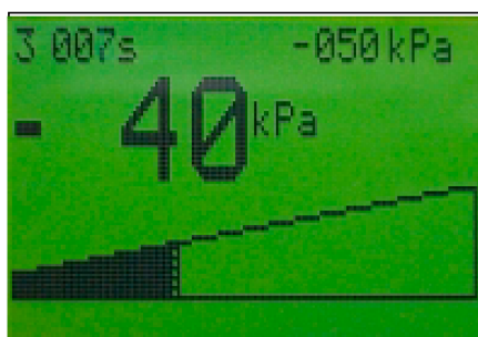
Obr. 21 Zobrazení displeje ve 3. fázi: Vakuum je během této fáze úplně snižováno. Zbývající doba do konce 3. fáze je zobrazena vlevo nahoře (zde: 7 s).
