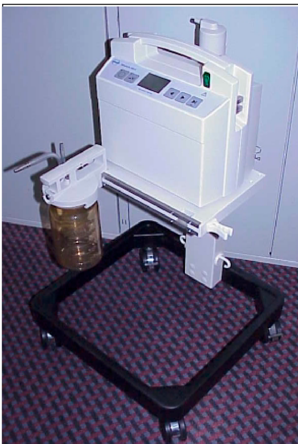
Obr. 6 Zavěšení 3litrové nebo 5litrové nádoby na přístrojový vozík
