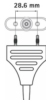
Fig. 12 Connecteur à 2 broches
