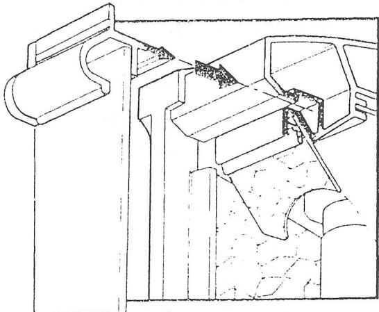
9 Před zasunutím reflektoru zpět do plastikové štěrbiny vložte zpět na své místo obě černé svorky. Nainstalujte zpět průsvitnou desku.
