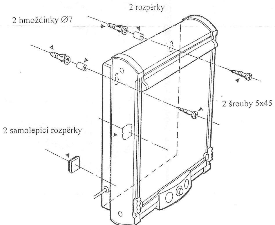
**UPOZORNĚNÍ!** Pro zajištění správné funkce by instalace výrobků této řady měla být prováděna přesně podle těchto instrukcí.
