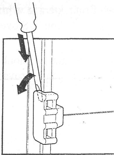
Posuvný drát odstraníte páčivým pohybem pomocí šroubováku zasunutého za unašeč.
