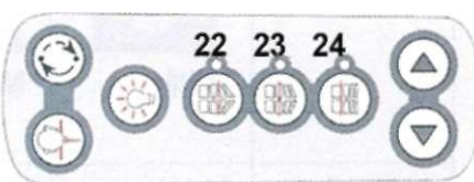
Obr 5.28. Polohovací panel na pravé straně. Tlačítka pro nastavení okluze: 10 mm vzad (22), střed (23), 10 mm vpřed(24).
