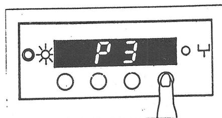
3.3 Na displeji se ihned ukáže do paměti uložená dozovací doba pro zvolený program a míchací kapsle vibruje. Tím bezprostředně začne dozování.
