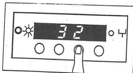
3.5 Při opětném stisknutí knoflíku "Progr.-Time" se na displeji objeví "P1", stiskneme-li tentýž knoflík opět, na displeji se objeví doba zvolená pro program P1 (v našem případě 32 sek., obr. 8).
